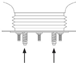
Para endurecer el movimiento del mecanismo basculante apretar las 2 tuercas en el sentido de las agujas del reloj.
